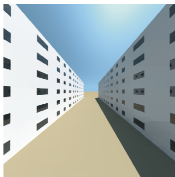
Figura 3: Imagem gerada pelo programa RADIANCE da geometria de rua para um ratio 1:1.
